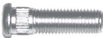
561-110 M12 x 1.5 x 43mm Knurl diameter: 13mm (Code M.1.7)
