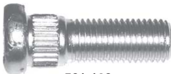
561-108 M12 x 1.5 x 38mm Knurl diameter: 14.3mm (Code M.1.0)
